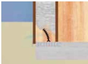
WATER STOP convencional que se necesita termofucionar y muchas veces no se hace bien provocando el paso de agua.
